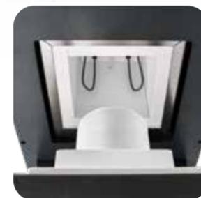
Hochwertige Heizelemente aus Molybdän Disilid erreichen eine maximale Endtemperatur von 1650°C. Im Gegensatz zu Heizsystemen aus Siliziumcarbid sind Heizungen diesen Typs dabei ausreichend von ihrer höchsten Leistungsgrenze von ca.1800°C entfernt. Dank dieser Eigenschaft erreichen sie eine signifikant höhere Lebensdauer. Jedes der vier Heizelemente kann im Schadensfall einzeln ersetzt werden, ein Tausch „en bloc“ entfällt.
