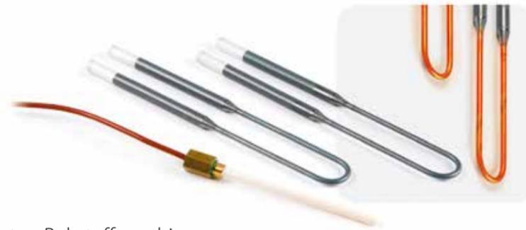
Hochwertige Heizelemente aus Molybdän Disilid erreichen eine maximale Endtemperatur von 1650°C. Im Gegensatz zu Heizsystemen aus Siliziumcarbid sind Heizungen diesen Typs dabei ausreichend von ihrer höchsten Leistungsgrenze von ca.1800°C entfernt. Dank dieser Eigenschaft erreichen sie eine signifikant höhere Lebensdauer. Jedes der vier Heizelemente kann im Schadensfall einzeln ersetzt werden, ein Tausch „en bloc“ entfällt.
