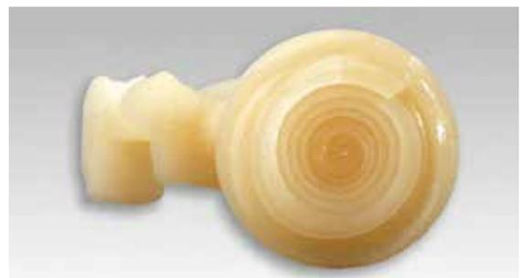
Keramikbutton mit Alox-Stempel gepresst
