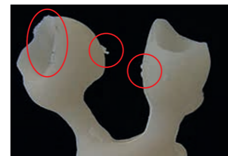
Photo 1 - Sur pressées sur le bord à cause de fissures dans le cylindre.
